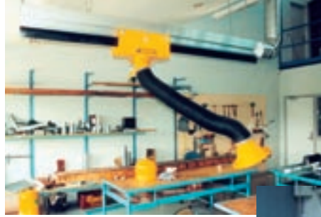
Sledekanal for vogn med teleskoparm 1.4 til 3.0m
